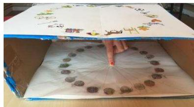
**Figure 6 : Dispositif de mesure de l'acuité kinesthésique des membres supérieurs**
